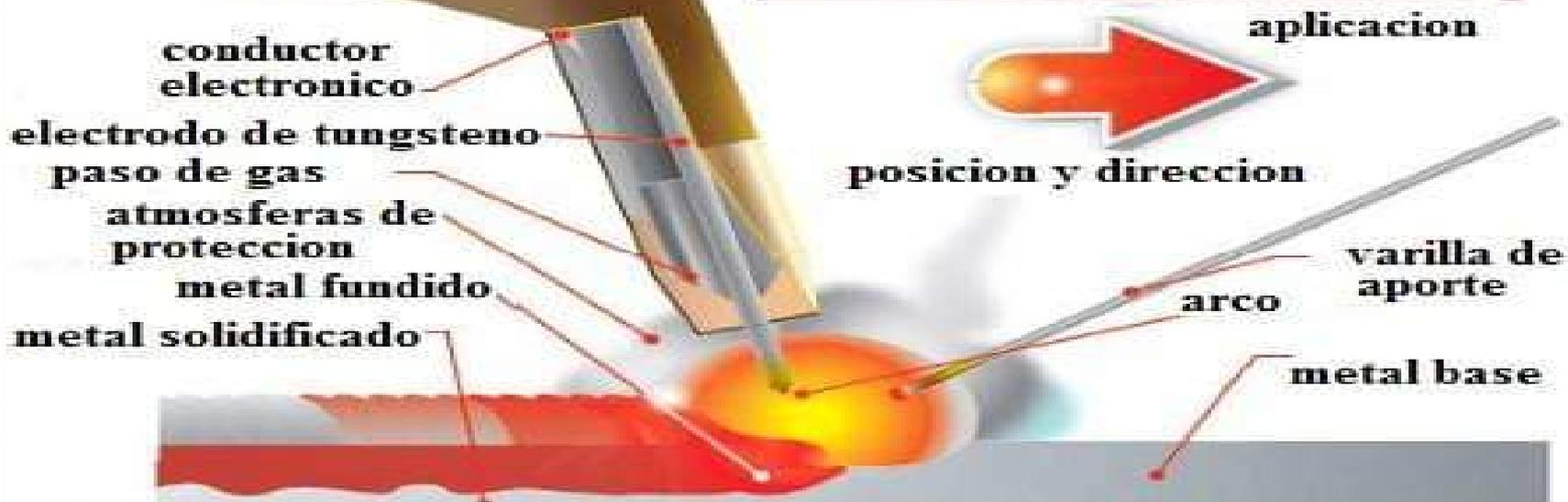
**Nota:** La Sociedad Americana de Soldadura (por sus siglas en inglés AWS) denomina a este proceso de soldadura como GTAW (Gas Tungsten Arc Welding).
