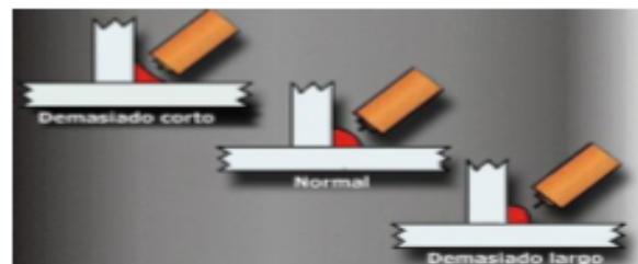
Figura 29. (A) Longitud de arco apropiada para obtener una transferencia por corto circuito para el caso del soldeo de una unión en ángulo y (B) posición para la pistola en soldeo en ángulo
