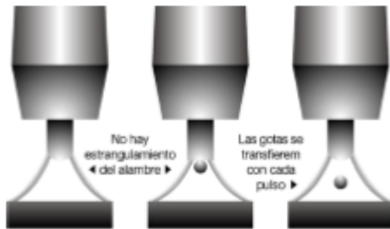
Figura 6. (A) Transferencia con arco pulsado. (B) Gráfico Intensidad–Tiempo de transferencia por arco pulsado de la onda
