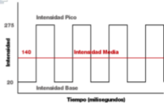
Figura 6. (A) Transferencia con arco pulsado. (B) Gráfico Intensidad–Tiempo de transferencia por arco pulsado de la onda
