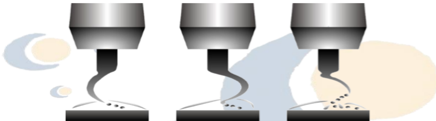
Figura 7. Transferencia con elevada densidad de corriente. Arco largo rotacional
