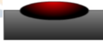
Figura 32. (A) Voltaje de arco con diferentes gases, efecto de los gases de protección (B) argón y (C) helio en el tipo de cordón en la soldadura de aluminio y penetración y contorno del cordón con (D) argón, (E) helio y (F) mezcla de argón y helio
